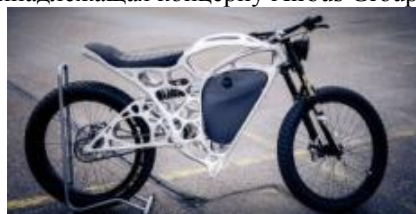
Рис. 4 Мотоцикл, напечатанный на 3D-принтере
