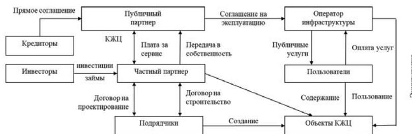
Рис. 7.4. Схема реализации контракта жизненного цикла
