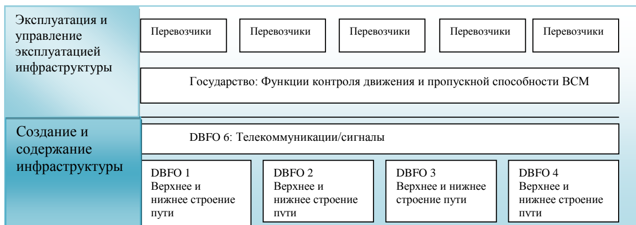
Рисунок 21 — Декомпозиция проекта на суб-проекты на примере строительства ВСМ в Португалии.
